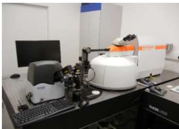
Obr. 1: Propojení Ramanova spektrometru s mikroskopem se vzorkovací sondou – systém pro TERS
