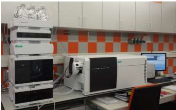
HPLC systém Agilent Infinity 1290 II s DAD detektorem a hmotnostním spektrometrem (QqQ) v Laboratoři analytiky vody Ústavu technologie vody a prostředí VŠCHT Praha
